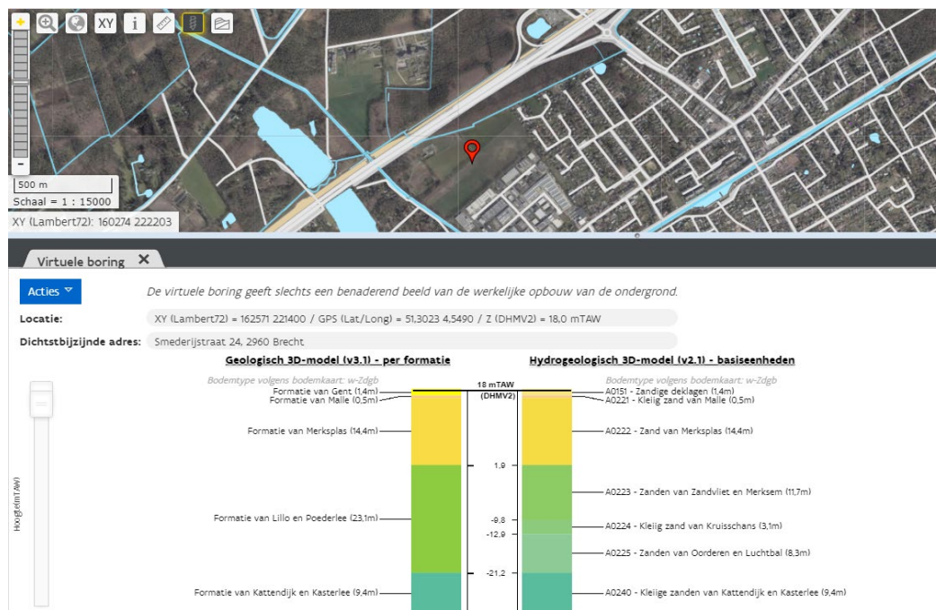
Figuur 28 Virtuele boring in het onderzoeksgebied (Databank Ondergrond Vlaanderen)
